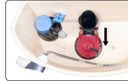
**NOTA:** No cubra los agujeros para los pernos del tanque con la válvula de descarga. Si la válvula de descarga cubre uno de los agujeros de los pernos, gire la válvula de descarga un poco hacia la derecha (tubo de desagüe hacia la derecha) para destapar el agujero del perno. En algunos casos, colocando primero los pernos en los agujeros puede ser necesario.
